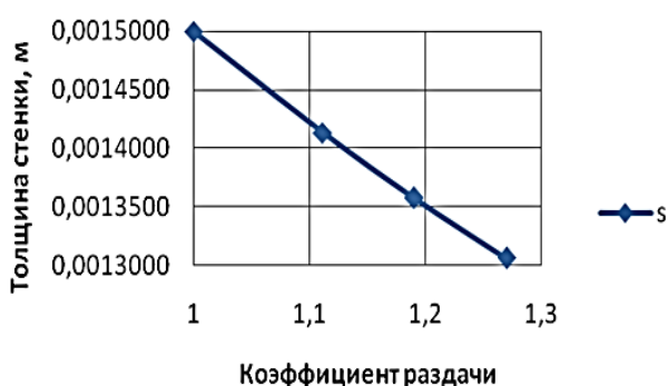
Рис. 4. График изменения толщины стенки трубной заготовки при раздаче коническим пуансоном
