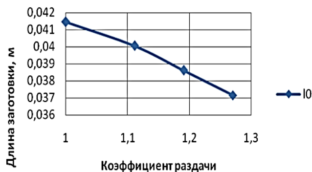
Рис. 5. Влияние коэффициента раздачи на изменение длины участка трубной заготовки, необходимого для раздачи на конус
